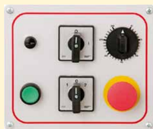
Bedienfeld mit Zeitschaltuhr für Maschinen mit zwei Knetgeschwindigkeiten
