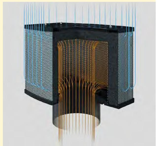
Die Perforation im Edelmantel des Aktivkohlefilters bleibt durchlässig, und die leistungsstarke Aktivkohle kann bis zu 97 % der lästigen Gerüche binden.
