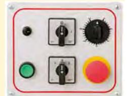
Bedientafel mit Zeitschaltuhr für Maschinen mit zwei Knetgeschwindigkeiten
